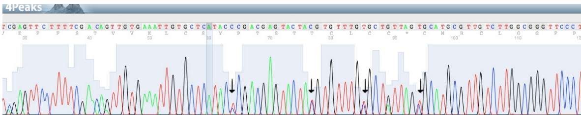
Fig. 20 : Elettroferogramma del campione 2/3A in cui si evince la presenza di eterozigosi a 4 loci SNP (indicati dalle frecce nere)
