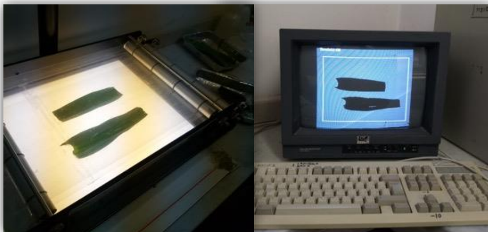
Figura 40: Misurazione della superficie fogliare tramite analisi delle immagini
