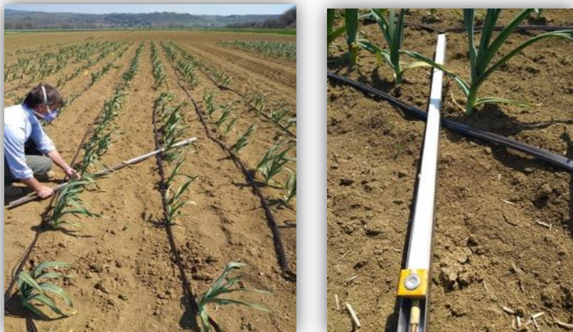
Figura 44: Misura della radiazione fotosinteticamente attiva (PAR 400-700nm) con sensore lineare
