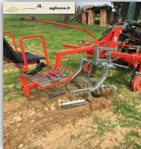
Figura 17: Sarchiatrici per il controllo delle infestanti tra le file, sulla fila e rincalzatura dei bulbi
